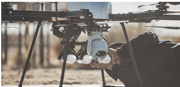
2024년 11월 캘리포니아 캠프 윌슨(Camp Wilson)에서 열린 국방혁신부 블루 UAS 리프레시 챌린지(Defense Innovation Unit Blue UAS Refresh Challenge)에서 민 드론 기술자가 페리미터 8(Perimeter 8) 무인항공시스템(Unmanned aerial system, UAS)에 시뮬레이션 페이로드를 장착하고 있다. 리처드 페레즈가르시아(RICHARD PEREZGARCIA) 촬영/미국 해병대
